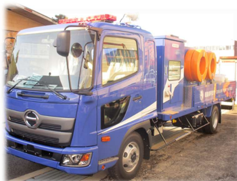
高性能排水ポンプ車
