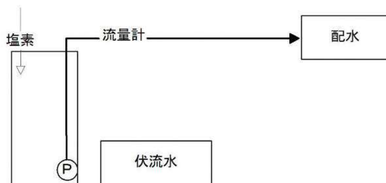
図 2-16 浄水フロー (王地水源地)
