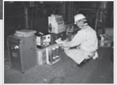
場内排ガス調査▶
